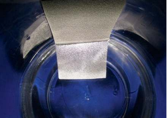
Bild 2 > Beim Eintauchen einer beschichteten EPDM-Platte in Wasser werden Luftbläschen in der Struktur eingeschlossen und verhindern so die Benetzung.
