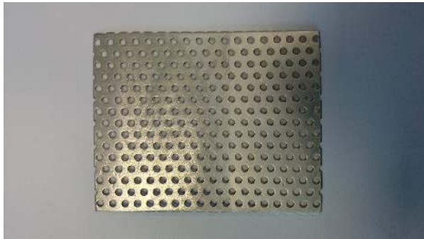
Abbildung4: Alubackblech unbeschichtet vor Test
