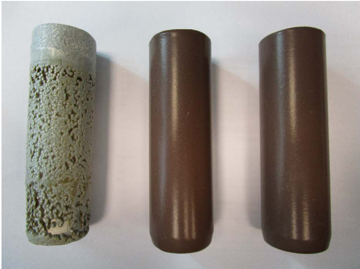
Abbildung3: Probe1, 2 und 3 (von links nach rechts) nach 90h in 4%iger NaOH
