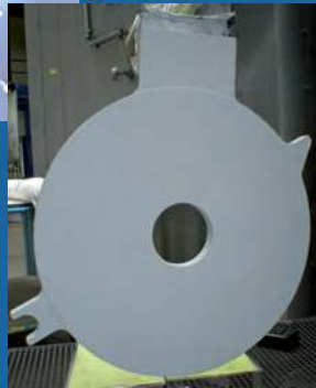
Heizplatte für Kunststoffrohre
