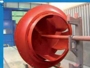
Lüfterrad für Naß- lackierbereich
