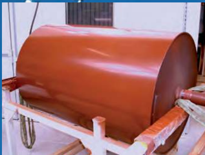
Heizylinder für PE-Folien
