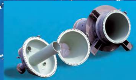
Reaktionsbehälter zur Herstellung von Polyethylen
