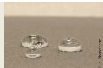
▲ Technische Umsetzung – mikrostrukturierte, hydrophobe Metalloberfläche
